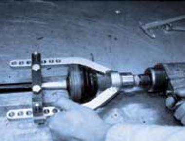
*Bei Gelenken mit innenliegendem, unsichtbarem Sicherungsring sowie bei Profilwellen ohne Gewinde: treiben Sie das Gelenk von der Profilwelle ab. Nehmen Sie dafür den Gelenkzieher (Art. Nr. 190250) oder schlagen Sie mit einem Kunststoff- bzw. Gummihammer auf die Stirnseite des Gelenks.*
