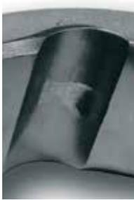
Deutlich sichtbare Verschleißspuren mit tiefen Grübchen in den Kugellaufbahnen.
