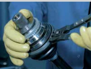
13 Spannen Sie den Schlauchbinder so straff wie möglich von Hand vor. Schließen Sie ihn dann mit Hilfe einer Zange (z.B. Art. Nr. 190135).
