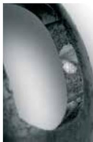
Kantenabplatzungen in einem oder mehreren Fenstern.
