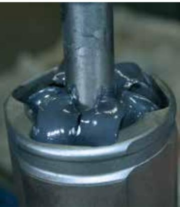
Beim Einsatz eines Standard-Schmiermittels in einer Hochleistungs-Anwendung kann es zum Ausgasen des Fetts und letztlich zum Totalausfall des Gelenks kommen.
