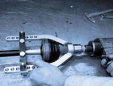
*Les joints équipés d'un jonc d'arrêt intérieur (invisible) et arbres sans filetage doivent être extraits à l'aide d'un extracteur de joint (no. de pièce : 190250). Sinon vous pouvez aussi les extraire par tapotements à l'aide d'une massette à embouts en plastique ou en caoutchouc sur la face du joint.*
