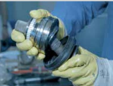
7 Placez un jonc d'arrêt dans la gorge du moyeu à billes. Les deux extrémités du jonc d'arrêt doivent être dans le renforcement extérieur.
