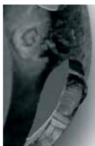
Signes d'usure sur les contours intérieurs et extérieurs provoqués par un soudage à froid (peut apparaître sur les joints fixes côté roue).
