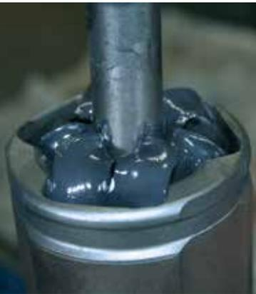
L'utilisation d'un lubrifiant standard pour une application haut niveau peut conduire à un dégazage de la graisse qui, au final, se traduit par une défaillance complète du joint.
