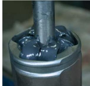
Un sortiment bogat de lubrifianti este disponibil pentru articulațiile cu bilă și trepied, precum și pentru aplicațiile standard și de performanță ridicată. Ingredientele sunt ajustate perfect la oțelul articulației și la burdufurile pentru aplicația respectivă. Aceasta facilitează funcționarea fără impiedimente a componentelor.
