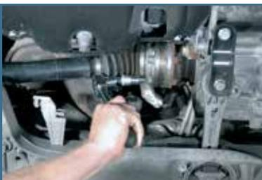
制动固定传动轴。旋松差速器侧的万向节螺栓。
