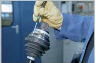
将护套拉到万向节上的正确位置。
