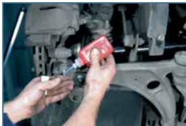
11 拧紧车轮架。使用新的螺栓并固定。考虑制造商安全措施。
