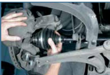
10 将传动轴插入轮毂。始终记住使用提供的所有零件！利用汽车制造商推荐的专门工具。接合后通过拉动万向节检查就位是否牢固。
