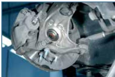
7 清洁轮毂壳体和差速器法兰表面。表面必须没有灰尘。
