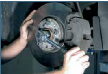
12 在外侧状态使用垫圈。根据汽车制造商说明使用传动轴螺母并拧到指定扭矩。注意：只能使用新的螺母！安装车轮。
