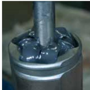
不同的万向节润滑油用于不同系列的球式和三销式万向节以及标准和高性能应用。其成分已经过充分调整，以分别适用于万向节和护套的不同材质。这使得部件可顺畅工作。
