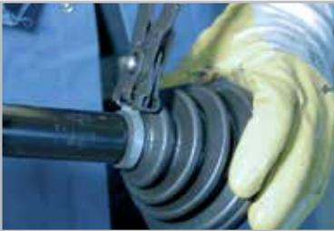
用卡钳锁定固定卡夹。将卡环置于球形轮毂的槽中。两个卡环柄均应位于凹槽的外侧。如果必须将卡环置于内侧，则将其置于柄槽内。
