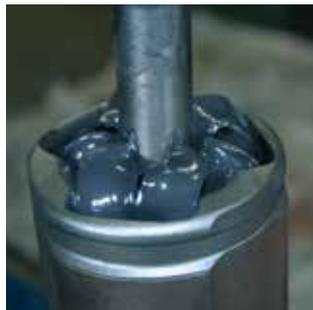
Pro kloubové spoje a tříramenné klouby jsou, stejně jako pro standardní a vysokovýkonná použití, různá maziva. Složky jsou pro příslušná použití perfektně uzpůsobené oceli kloubu a manžet. To umožňuje plynulou činnost komponentů.
