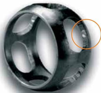
Znaky opotřebení na vnitřních a vnějších profilech způsobené svařováním za studena (může nastat u pevných kloubů ke kolu).
