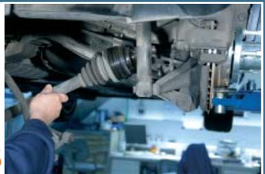
Puxe a transmissão para fora do cubo da roda. Limpe a caixa do cubo da roda e a superfície da flange do diferencial.
