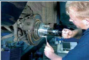
Retire a junta da transmissão. Se for necessário, utilize a ferramenta especial recomendada pelo fabricante do veículo.
