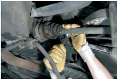
Desaperte os parafusos da junta do lado do diferencial.
