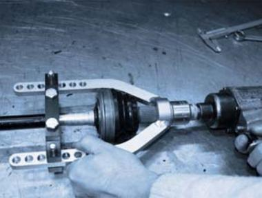
*I giunti fissati con l'anello di bloccaggio
