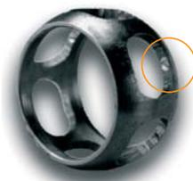
Segni di usura sui bordi interni ed esterni possono derivare da saldature a freddo (potrebbero verificarsi sui giunti fissi lato ruota).
