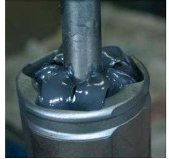
Para juntas de esferas e juntas tripóides bem como para aplicações padronizadas ou de alto desempenho, existem lubrificantes variados. Os ingredientes estão perfeitamente adaptados ao tipo de aço da junta e aos foles para a respectiva aplicação. Isto garante uma interacção dos componentes sem atrito.
